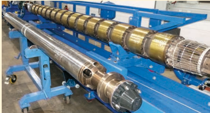
Abb. 1 Pumpenprototypen für unterschiedliche Förderraten (links: bis 100 l/s, rechts: bis 200 l/s)
